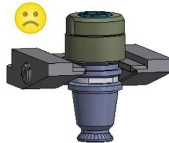
Falsch - Führungsschiene auf Gewinde!
